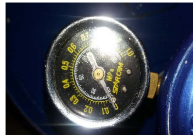
Gambar 9. Pengujian 2 menunjukkan angka 0 pada regulator gas (tanggal 28 maret 2016 - 10 April 2016)
