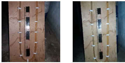
Gambar 11. Pengujian 4 menunjukkan kenaikan air pada manometer U (21-22 Mei 2016)
