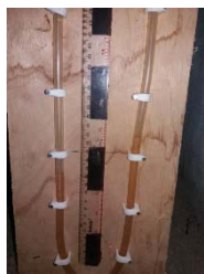
Gambar 12. Penurunan tekanan setinggi 2cm pada manometer U (23 Mei 2016)
