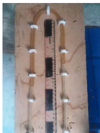
Gambar 14. Penurunan tekanan setinggi 2cm pada manometer U (24 Mei 2016)
