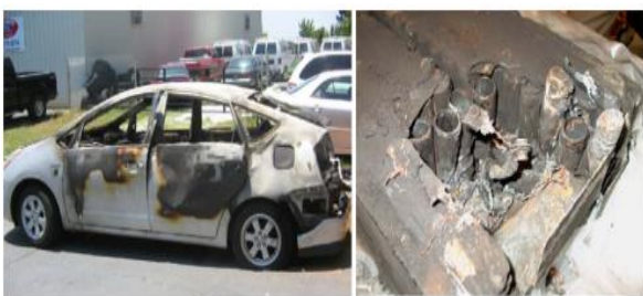
Gambar 2 Efek dari Thermal Runway (Wu dkk., 2019)
