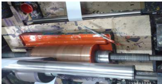
Gambar 5 Sisa tinta dari proses printing
