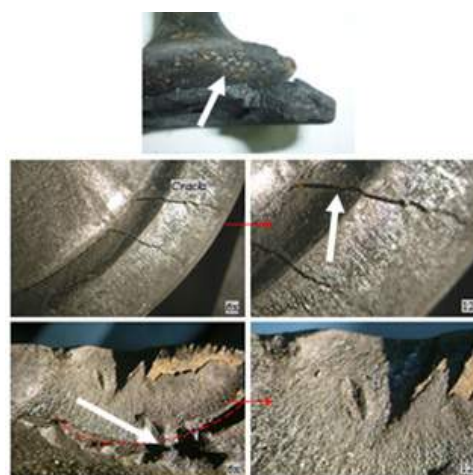
Gambar 5 Foto makro (exhaust valve) sampel katup A kondisi patah
