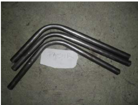
Gambar 17 Pipa Diisi dengan Pasir
