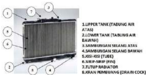
Gambar 2 Radiator dan bagian-bagiannya
