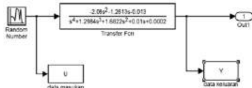
Gambar 4 Diagram blok pembangkit data masukan dan keluaran
