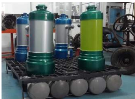
Gambar 2 prototipe instalasi pengolahan air banjir
