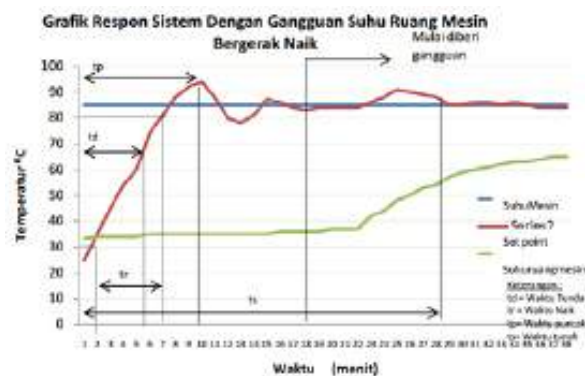
Gambar 21 Grafik respon transient sistem dengan gangguan kenaikan suhu ruang mesin
