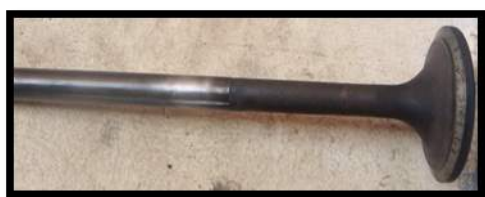
Gambar 4 Sampel katup hisap (inlet valve) pada permukaan katup terjadi deposite dan retakan
