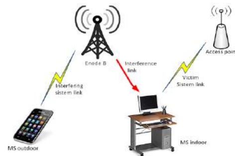
Gambar 4 Skema interferensi LTE terhadap WLAN 802.11 b/g
