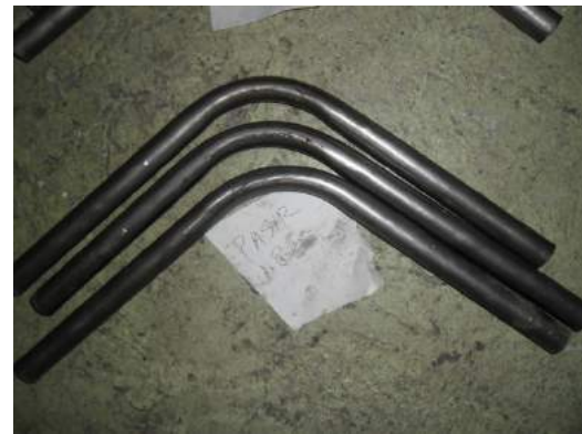
Gambar 20 Pipa Diisi dengan Pasir
