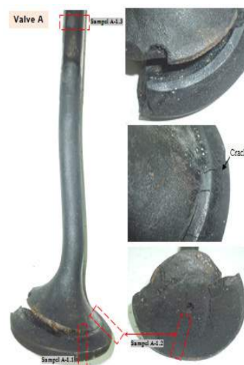
Gambar 6 Foto makro retak memperlihatkan menjalar melalui batas antara daerah yang dikeraskan dengan material dasar HAZ
