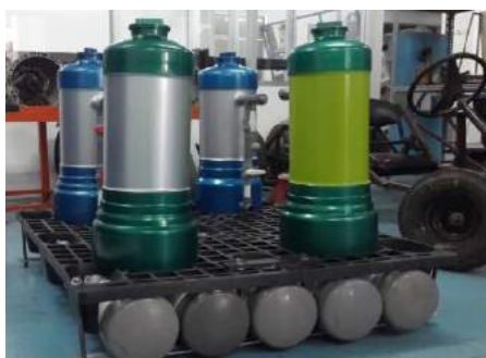
Gambar 2 prototipe instalasi pengolahan air banjir
