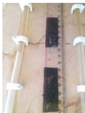
Gambar 10. Pengujian 3 menunjukkan kenaikan air setinggi 2cm pada manometer U (26 April 2016)
