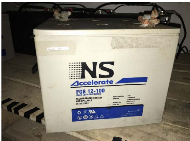
Gambar 14 Perangkat baterai 12V 100Ah yang digunakan dalam pengujian.
