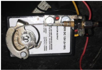
Gambar 9 Dimmer DC Yang Sudah Dimodifikasi
