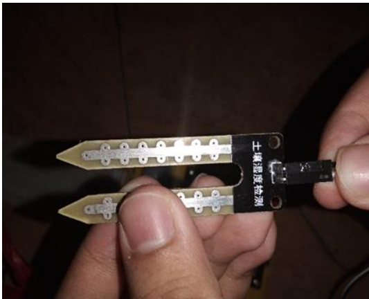
Gambar 11 Pemasangan sensor Moisture_1
