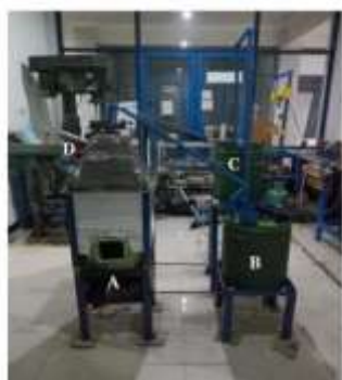
Gambar 1 Peralatan proses pirolisis sampah plastik, (A) reaktor distilasi, (B) kondensor pipa alur spiral, (C) tanki air pendingin, (D) temperatur indikator. [31]
