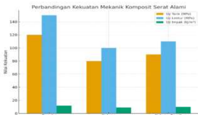
Gambar 5 Grafik perbandingan kekuatan tarik, lentur, dan impak komposit serat alami. Sumber: Disusun berdasarkan data [2], [7], [9], [11], [15], [18].
