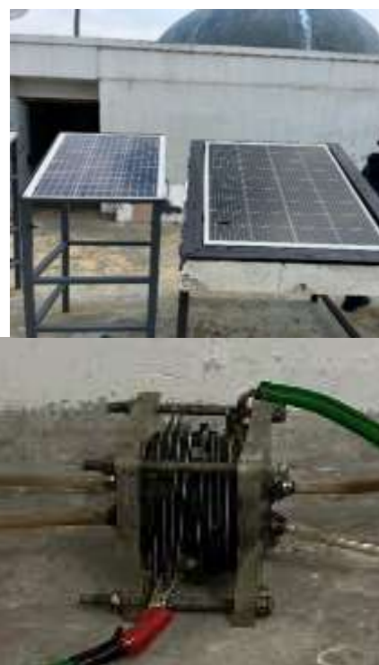
Gambar 9 Generator Hidrogen Kering (GHK)
