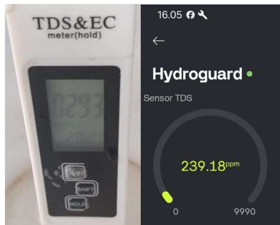
Gambar 6 Perbandingan TDS Meter dan Sensor TDS lewat monitor
