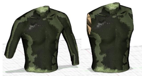
Gambar 2 Model Tubuh Sebelum dan Sesudah Remeshing
