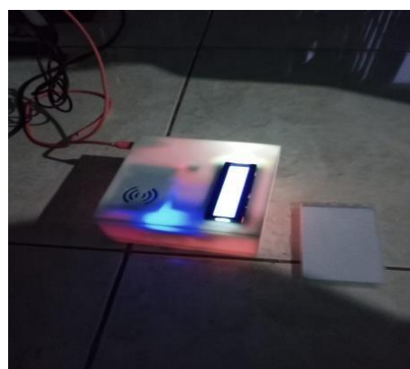
Gambar-5 Perangkat RFID+IoT
