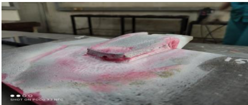
Gambar 10 Inspeksi las pada sampel preheating 150 °C dengan uji penetrasi
