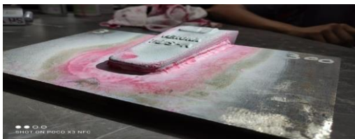
Gambar 11 Inspeksi las pada sampel perlakuan preheating 300°C dengan uji penetrasi
