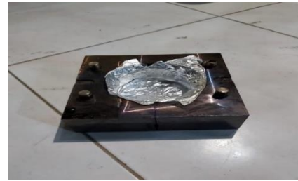
Gambar 12 Pemasangan alumunium foil
