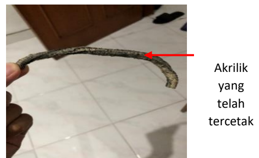
Gambar 4 Hasil percobaan ekstrusi panas
