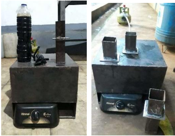
Gambar 8 Alat pelebur spesimen
