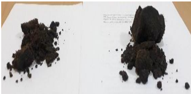
Gambar 21 Spesimen setelah proses peleburan dan proses pengeringan tidak berhasil
