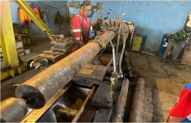
Gambar 2 Pemasangan Baja ST 45C pada Chuck
