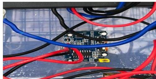
Gambar 11 Letak sensor pir di perangkat
