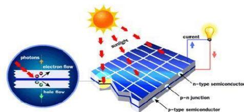
**Gambar 1** Ilustrasi cara kerja panel surya dengan prinsip *p-n junction*.
