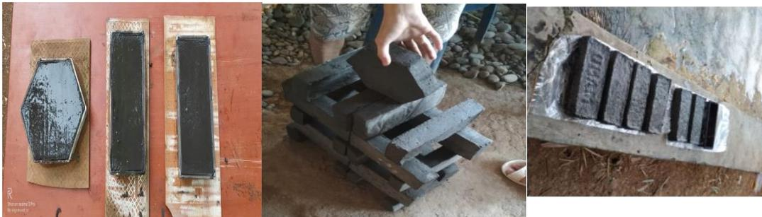
**Gambar 6 Paving Block dan Batako dari proses pengolahan Sampah**
