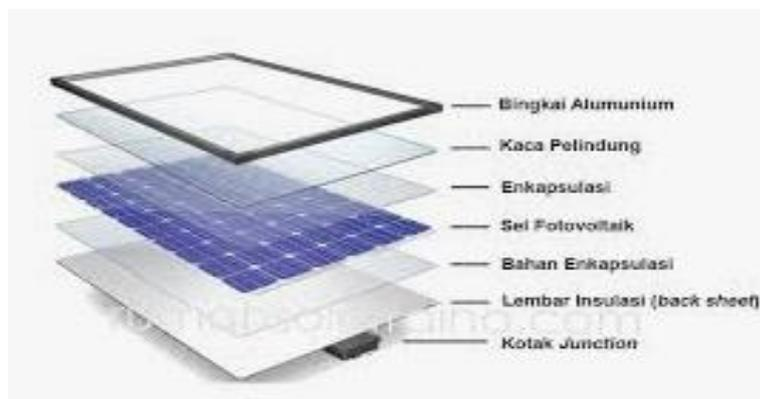
**Gambar 3.** Susunan Panel Surya.
