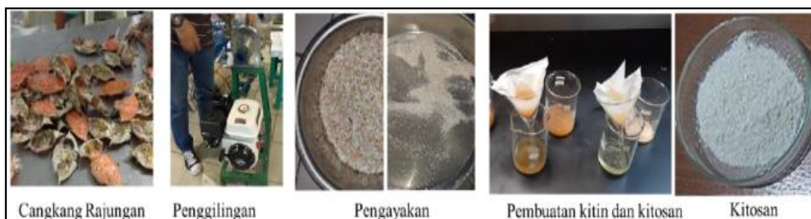
Gambar 2. Proses pembuatan kitin dan kitosan skala laboratorium
