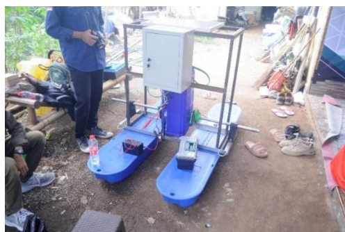
Gambar 3. Teknologi Aerator Berbasis Iot dan Panel Surya
