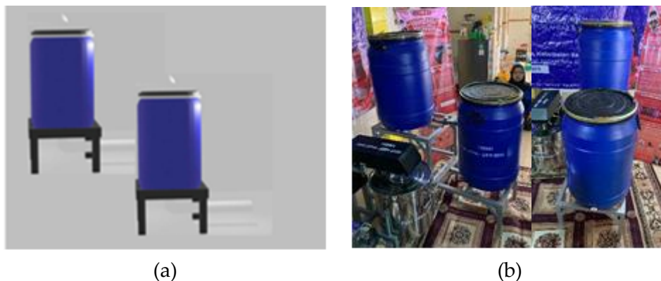
Gambar 2. (a) Desain 2 dimensi alat filter bertingkat limbah pemindangan ikan cakalang, (b) Prototipe alat filter bertingkat limbah pemindangan ikan cakalang lengkap.
