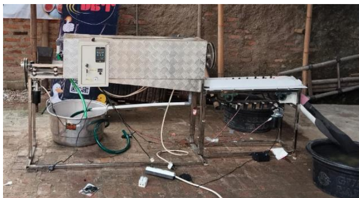
Gambar 4. Mesin Pencuci Telur Asin Otomatis
