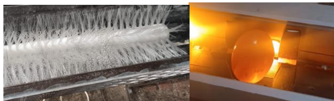
Gambar 5. Bagian Mesin Pencuci Telur Asin Otomatis. (a) Sikat Pembersih Telur, (b) Pencahayaan Pendeteksi Telur Busuk
