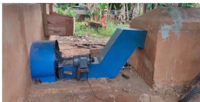
Gambar 2. Kipas dan saluran udara panas dari tungku ke oven pengering
