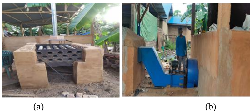
Gambar 3. Instalasi pengering gabah ((a)Tampak depan dan (b) tampak samping)
