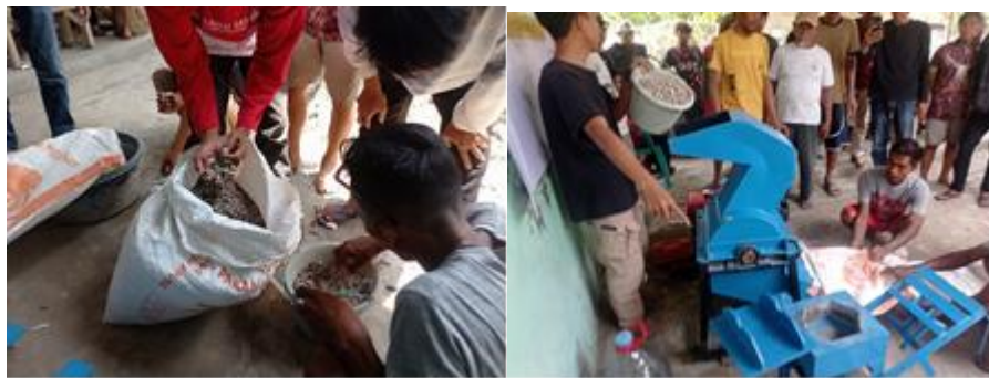
Gambar 2. Proses penghalusan limbah cangkang kerang menggunakan mesin penepung/penggiling
