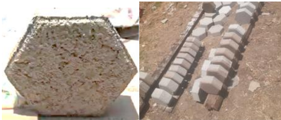
Gambar 5. hasil paving block pada awal pendampingan (kiri) dan setelah beberapa kali pembuatan (kanan).
