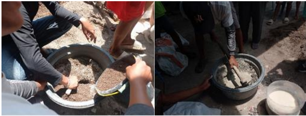
Gambar 3. Proses Pembuatan adonan/campuran paving block
