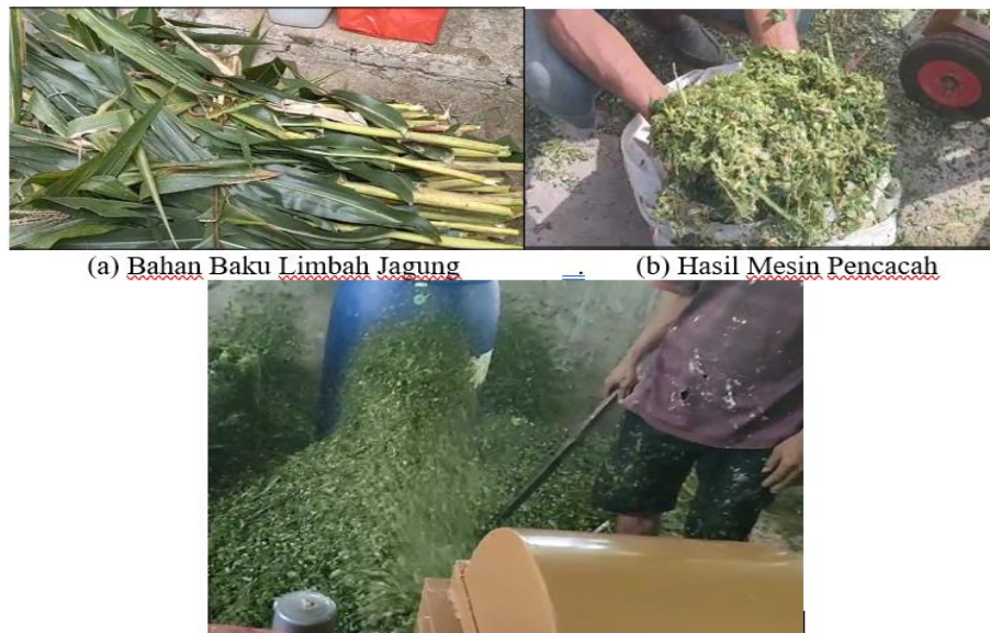
Gambar 5. Hasil Uji Coba Pencacah Pakan Ternak
