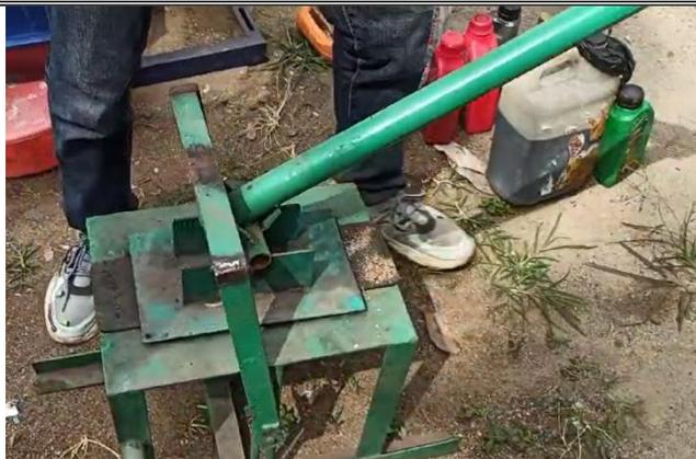
Gambar 5. Pengepresan Bata Plastik
