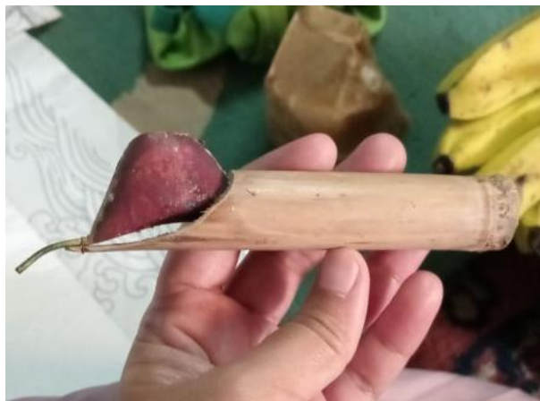
Gambar 1. Canting Manual yang digunakan oleh Pengrajin Batik di UMKM Kawis
