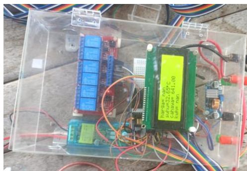
Gambar 3. Perangkat Keras Kontrol Smart Room dan IOT Konsumsi Daya Listrik
