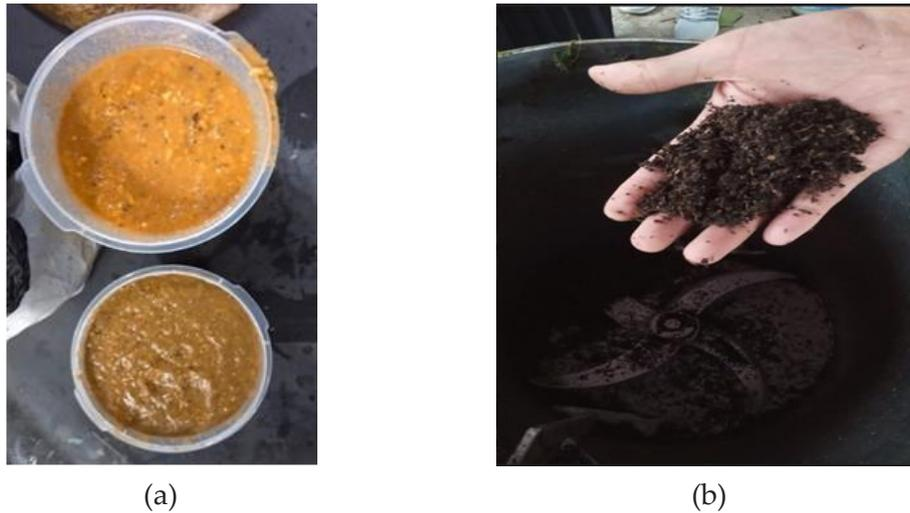
**Gambar 9.** Output mesin pelumat. (a) Bubur sampah; (b) Pupuk halus
