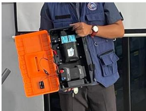
Gambar 5. Pengenalan alat semprot tanpa gendong menggunakan pompa DC.
