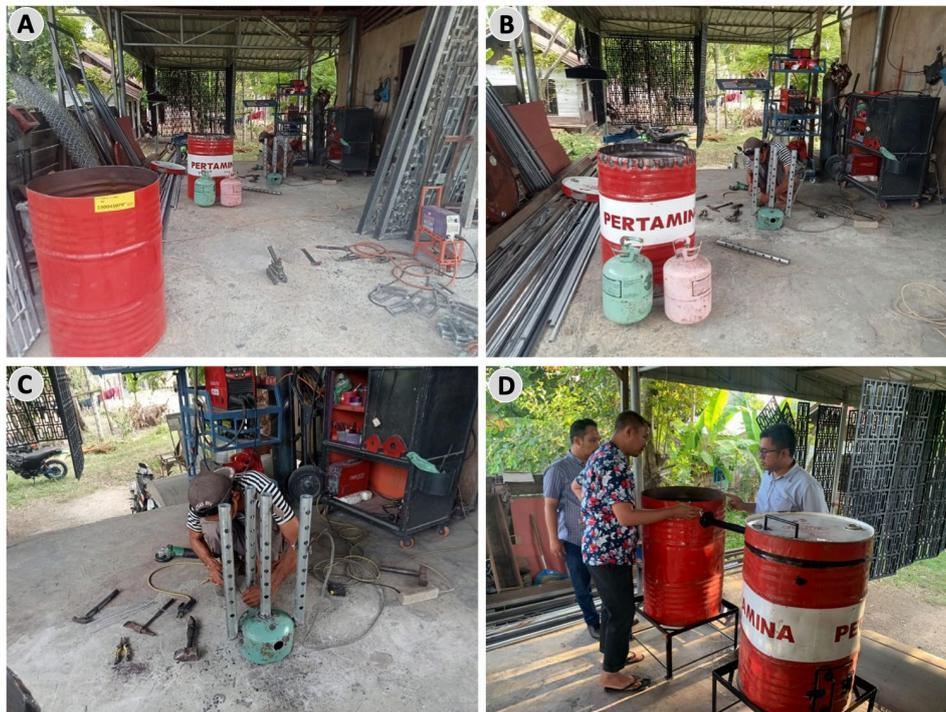
**Gambar 3.** Pembuatan alat asap cair. Keterangan: (A) Bahan pembuatan alat, (B) Perakitan alat pembuatan asap cair, (C) Perakitan alat asap cair. (D) Alat pembuatan asap cair selesai dikerjakan
