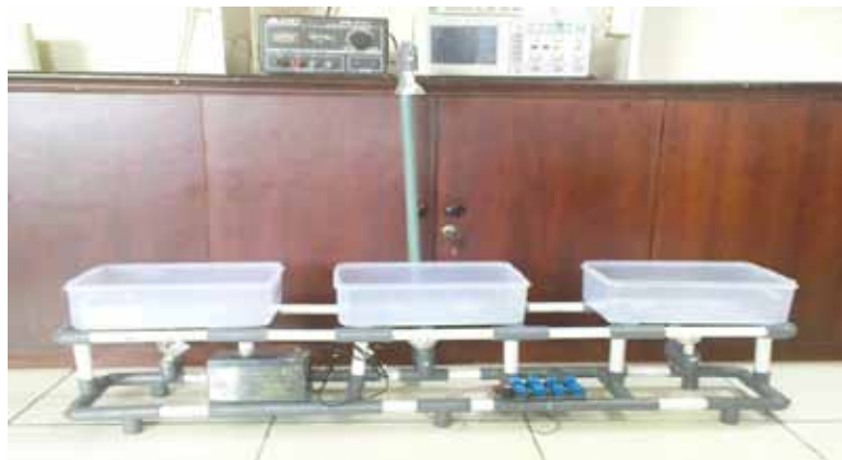
Gambar 6 Prototype perangkap serangga yang telah dirancang
