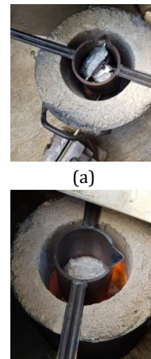
Gambar 8. Kondisi Aluminium Pada (a) Awal dan (b) Melebur
