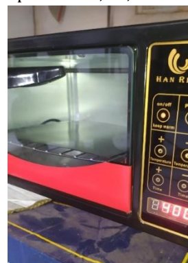
Gambar 2. Oven Pengering Cat yang digunakan sebagai Pengeringan Varnish
