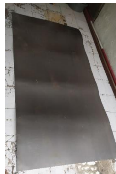
Gambar 1. Pelat SPCC yang digunakan Sebagai Material untuk dilapisi
