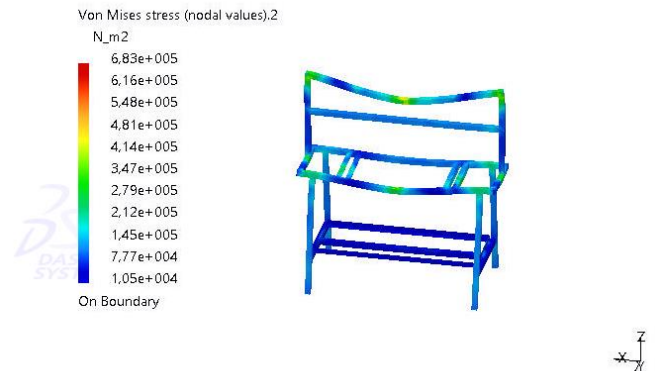
Gambar 5. Hasil pengujian stress analysis dengan beban 80 kg.
