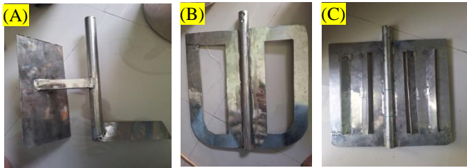
Gambar 5. Bentuk pengaduk, (A) memiliki sirip vertikal dan horizontal, (B) memiliki lubang besar ditengah, (C) memiliki 4 lubang sirip vertikal
