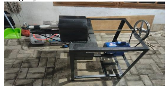
Gambar 4-2 model mesin perajang singkong menggunakan pendorong pneumatik
