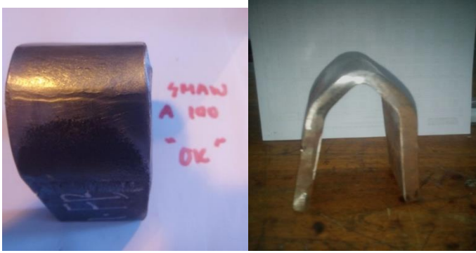
Gambar 10. Hasil uji bending 100 A.
