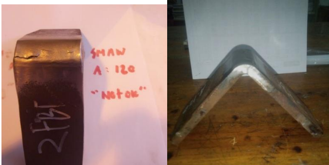
Gambar 11. Hasil uji bending 120 A.
