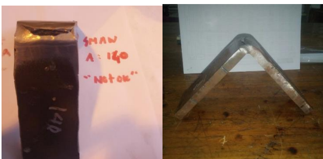
Gambar 12. Hasil uji bending 140 A.
