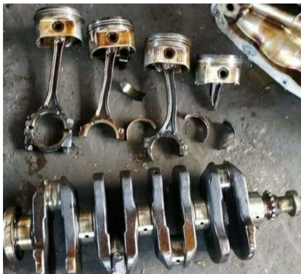
Gambar 5. Komponen batang piston yang patah.
