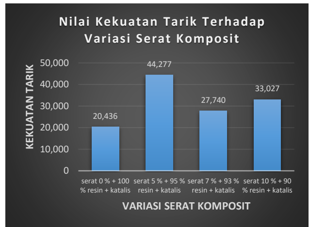
Gambar 7. Kekuatan tarik dengan variasi serat
