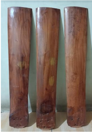
Gambar 6. merupakan hasil dari perancangan bilah inverse taper, dimana proses pembuatannya dilakukan secara manual dengan bantuan peralatan sederhana. Material yang digunakan dalam pembuatan bilah turbin angin adalah kayu mahoni.
