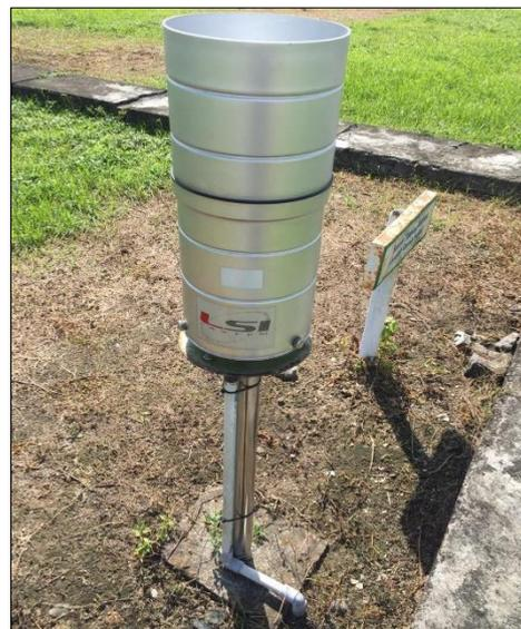
Gambar 4. *AWS* dengan sensor *tipping bucket*
