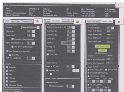
Gambar 3. Peta jalur terbang dan parameter pemotretan udara dengan UAV, menggunakan perangkat lunak Mission planner ; (1) Peta rencana jalur terbang, (2) statistik dari parameter foto yang dihasilkan pada perencanaan tersebut, (3) konfigurasi yang dapat diubah untuk merancang jalur terbang yang efektif
