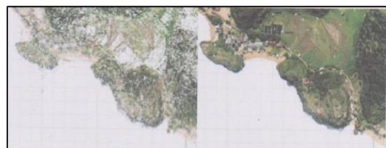
Gambar 10. Tahapan densifikasi point cloud dari (a) point cloud sebelum densifikasi, (b) Point cloud setelah densifikasi
