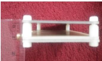
Gambar 4-30 Hasil fabrikasi antenna MIMO 1x2
